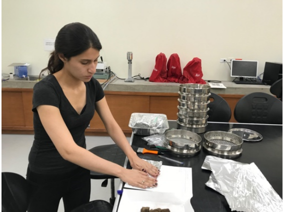
Figura 20. Proceso de tamizado de muestras para la distribución granulométrica.
