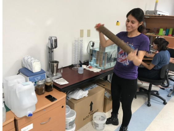
Figura 21. Proceso de sedimentación de muestras para la distribución granulométrica
