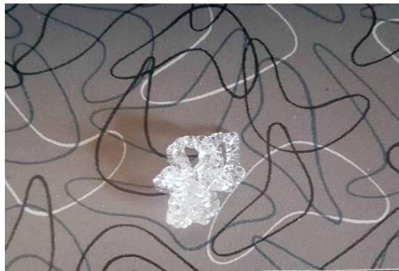
Figura 6. Impresión que se deforma por el tamaño.
