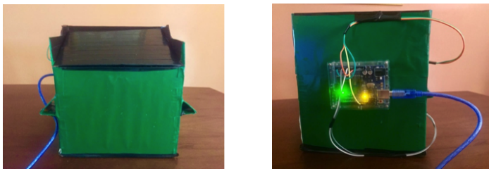
Figura 2. Prototipo de contenedor inteligente con sensores, microcontrolador y módulo Wi-Fi integrados.
