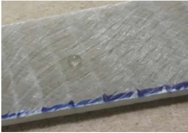
Figura 1. Muestra de una gota de agua sobre material con recubrimiento. Fuente: Elaboración propia.
