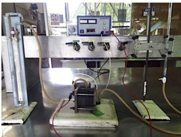
Figura 3. Dispositivo experimental para la parametrización de la celda de hidrógeno.
