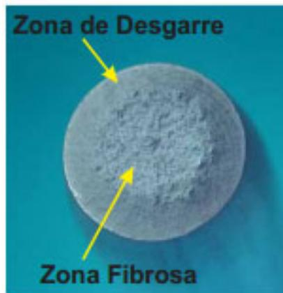
**Figura 6** Ejemplo de fractura dúctil
