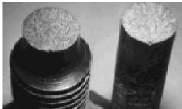
**Figura 2** Apariencia macroscópica de una fractura frágil.
