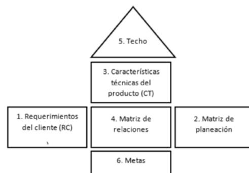
Figura 2. Función de despliegue de la calidad. (Muñoz et al., 2007).
