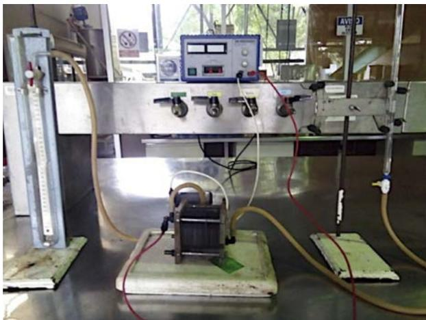
Figura 3. Dispositivo experimental para la parametrización de la celda de hidrógeno.
