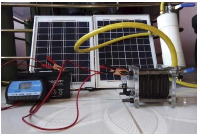
Figura 11. Electroizador alcalino diseñado.
