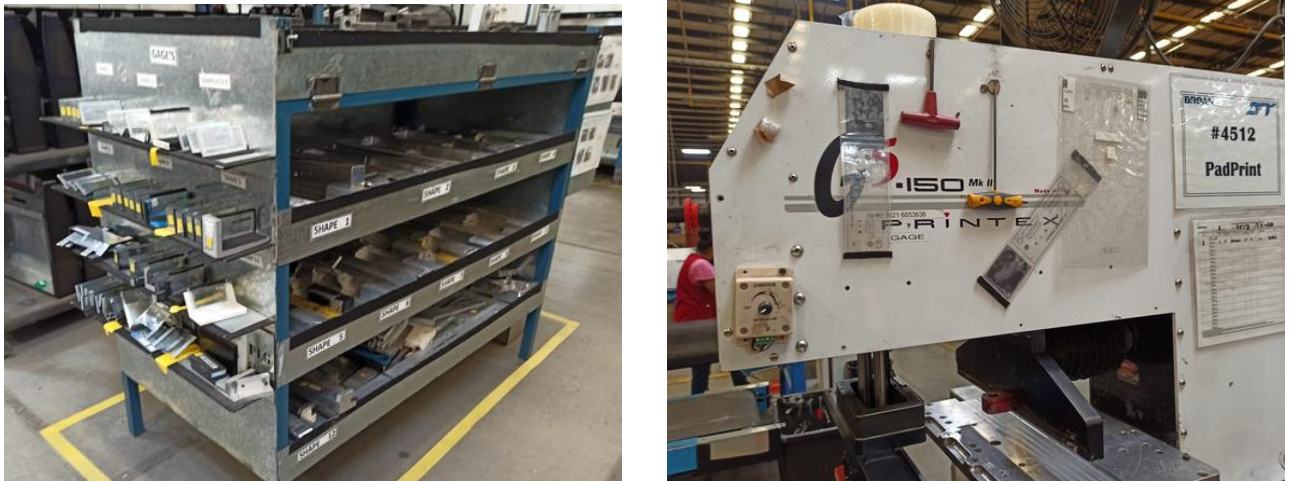
Figura 11. Fixturas y gages para cambios de modelo
