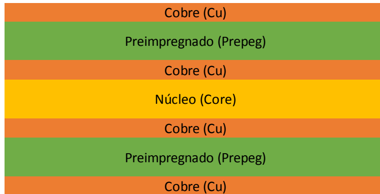
Fig. 2.4 Configuración de un PCB de 4 capas [10].
