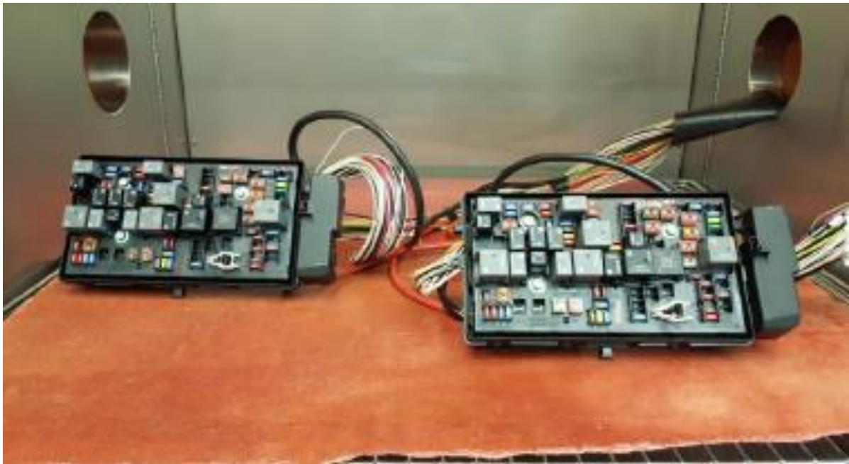
Fig. 4.11 Centrales electricas conectadas al arnes para correr pruebas de sobre voltaje.
