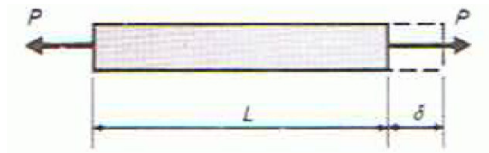
Figura 2.2 Deformación unitaria y total de una barra
