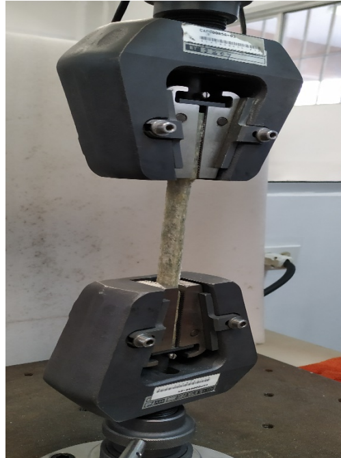
Figura 2.3 Prueba de tensión en probeta de RP colocada en máquina universal
