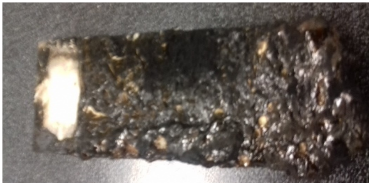
Figura 2.17 Probeta de RP despues de la prueba de inflamabilidad.
