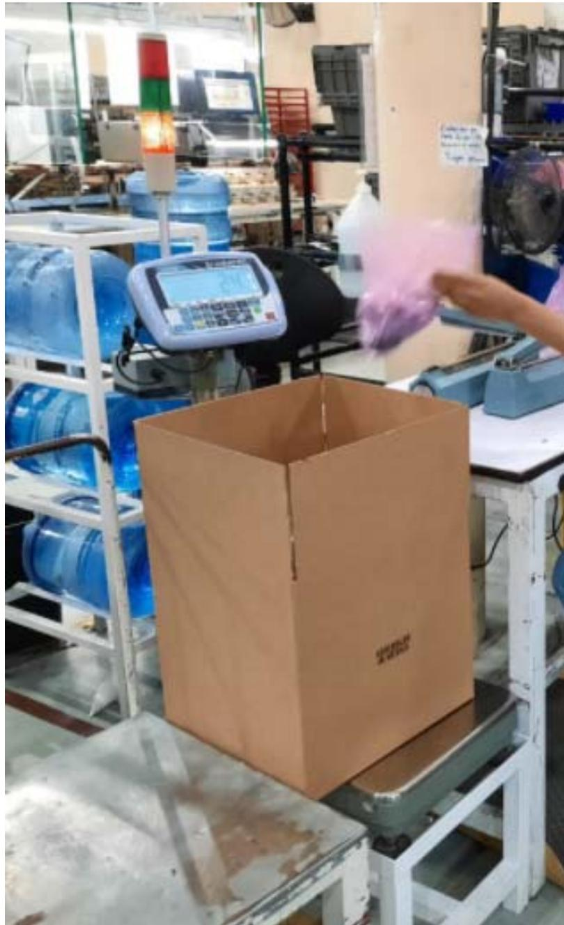
**Figura 9.** Pokayoke para evitar que las cajas se vayan con una cantidad equivocada de piezas.
