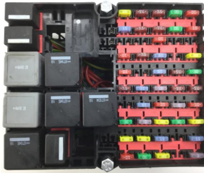
Figura 1. Un bloque de fusibles de un vehículo automotriz.
