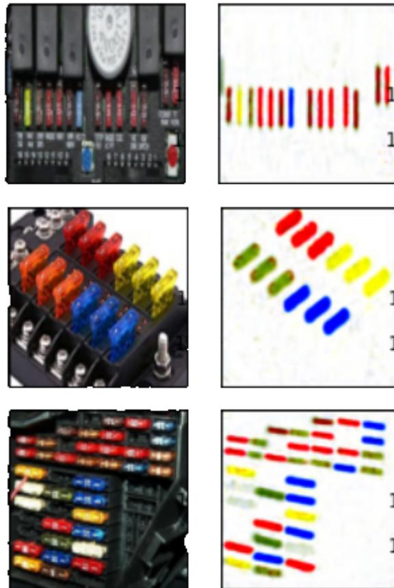
Figura 4. La primera columna muestra diferentes bloques de fusibles con diversas orientaciones y tamaños, además, con diferente iluminación. La segunda columna muestra la salida de la red, cada área mostrada en un fusible y su color el valor detectado.
