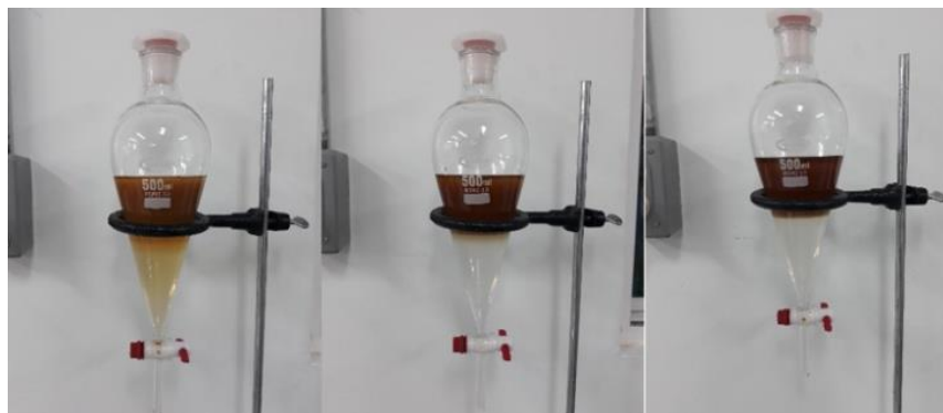
Figura 3. Lavado del biodiesel.
