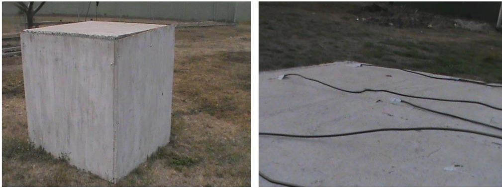
Figura 2. Prototipo experimental con techo de concreto de 1m x 1m x 1m utilizado para realizar las mediciones de temperatura
