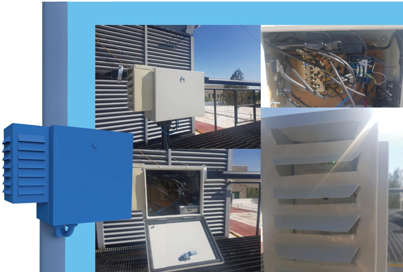
*En el verano de 2019 se rediseñó el prototipo, mejorando la colocación de los sensores, así como la resistencia de la caja de intemperie.*
