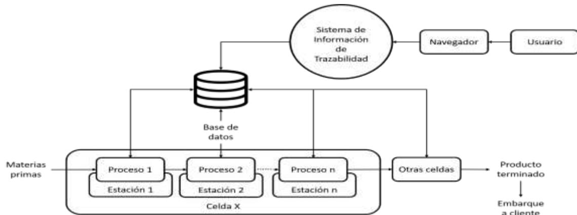
**Figura 2.** Funcionamiento general del sistema.
