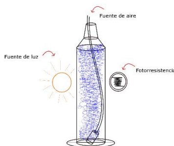
Figura 1. Columna de coalescencia
