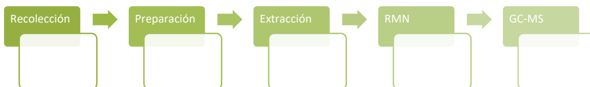
Figura 2. Metodología de la obtención-caracterización del aceite esencial de zacate limón.
