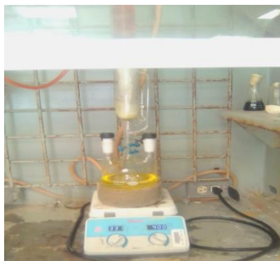
Figura 3. Extracción continua del aceite mediante Soxhlet
